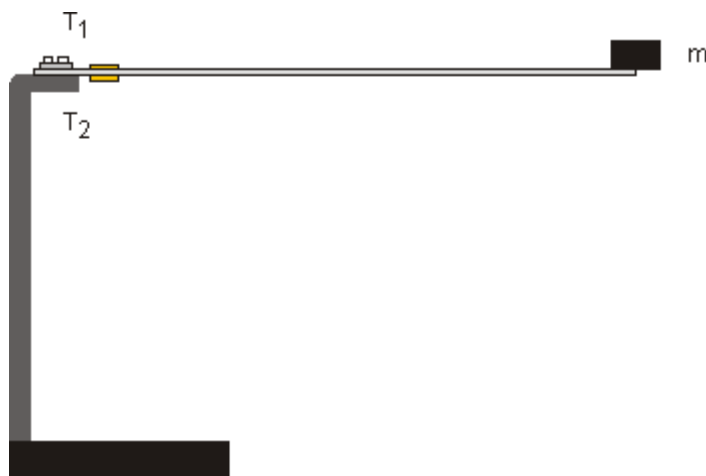
Obrázek 1 - Schéma měřicí aparatury pro měření netlumených kmitů
