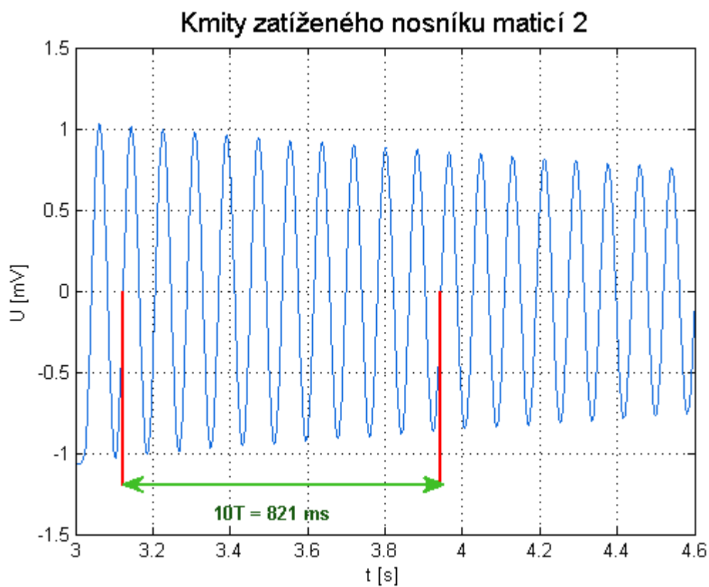
Obrázek 8 - Naměřené hodnoty kmitů nosníku zatíženého maticí 2
